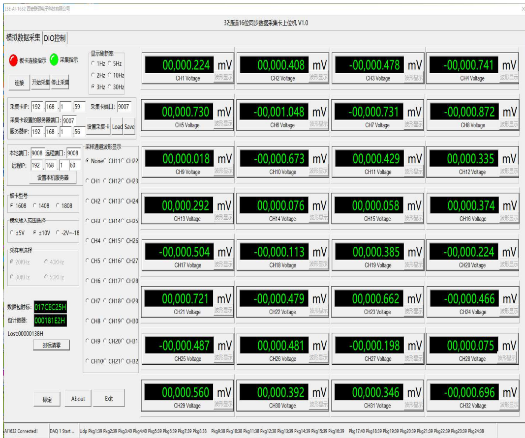
图三：16 位 32 通道数据采集卡上位机 Demo 程序界面
